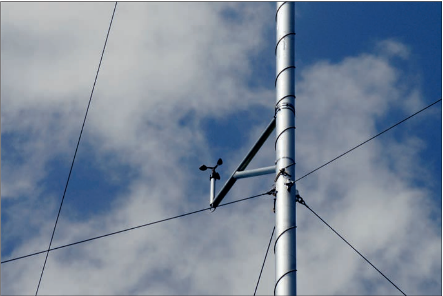
Leider drehte sich das Schalenanemometer zu wenig häufig und schnell.
